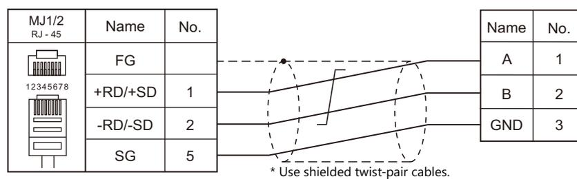
**Wiring diagram 4 - M4**
