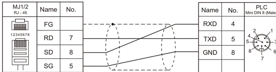
**Wiring diagram 2 - M2**
