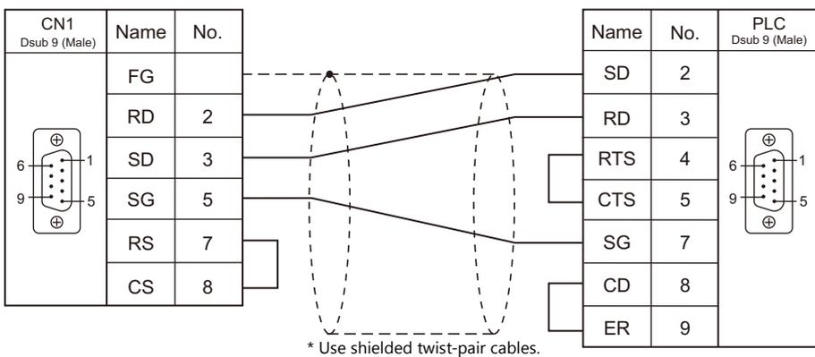
**Wiring diagram 4 - C2**
