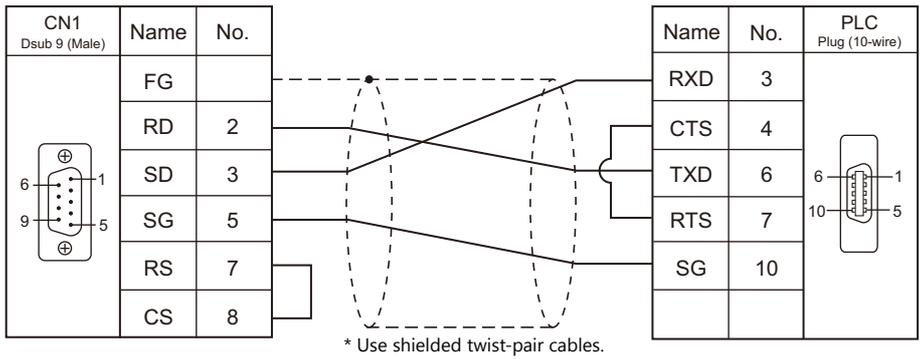
**Wiring diagram 5 - C2**
