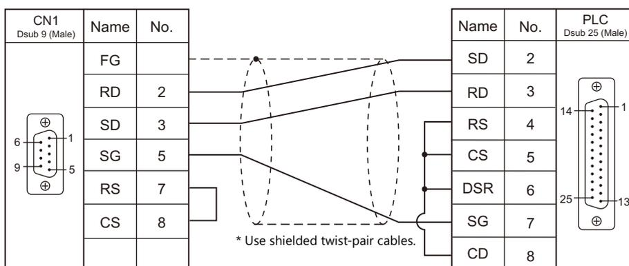
**Wiring diagram 4 - C2**
