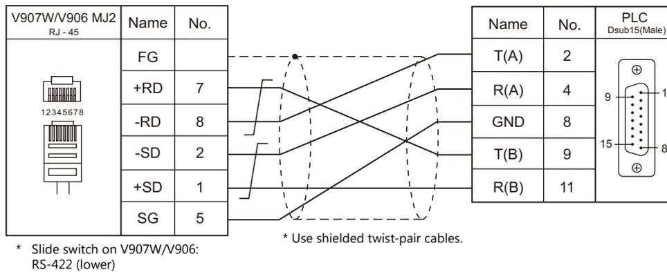
**Wiring diagram 4 - M4**
