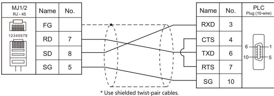
**Wiring diagram 5 - M2**
