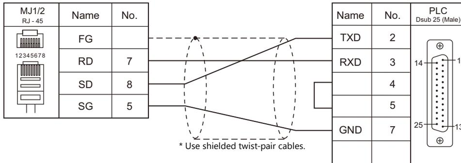
**Wiring diagram 3 - M2**
