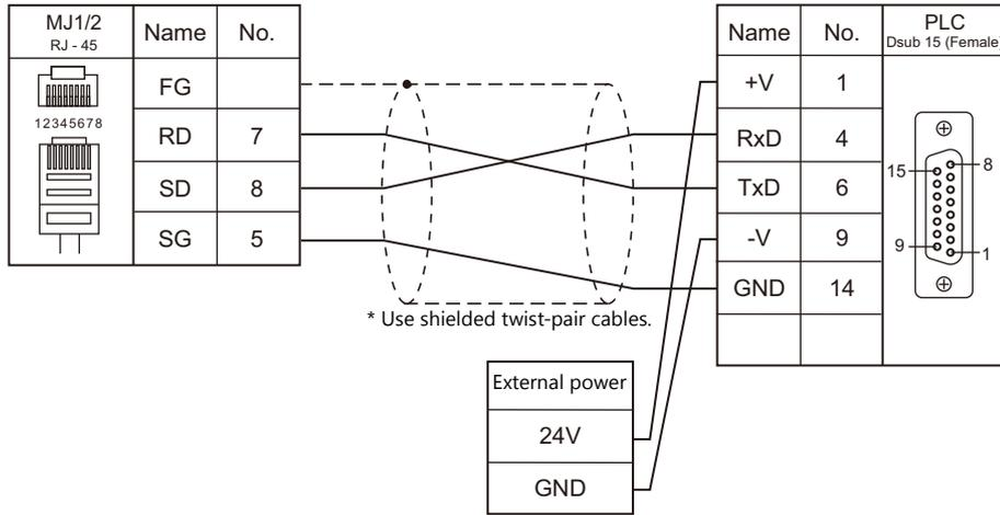
**Wiring diagram 2 - M2**
